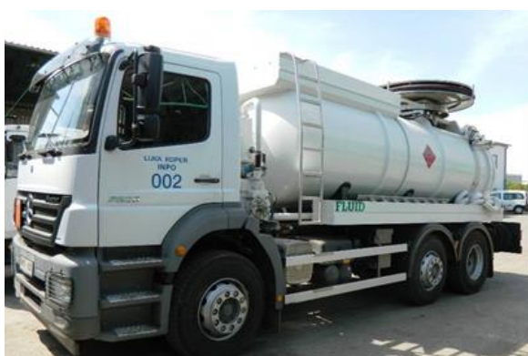
Slika 5: Tovornjak s cisterno za prevzemanje tekočih odpadkov
